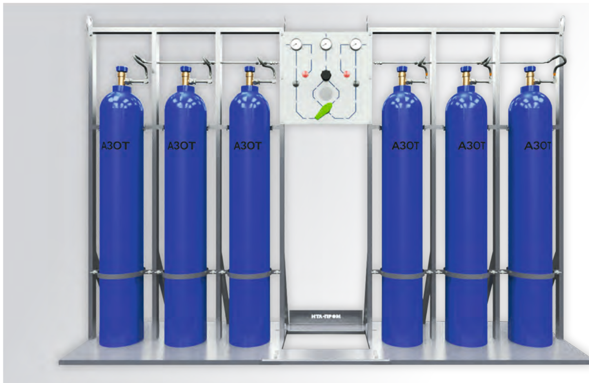
Система непрерывной подачи газа в панельном исполнении с автоматическим переключением (СНПГ-40), выбором основной или резервной группы баллонов
