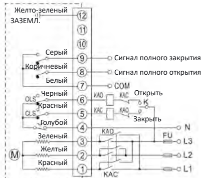
ТИП H: 3х-фазная цепь управления переменного тока (с переключателем пассивного контакта)
