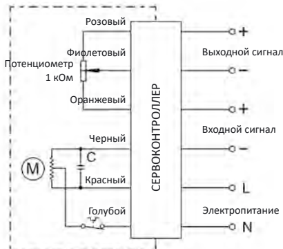
ТИП G: Цепь управления постоянного тока (с переключателем пассивного контакта)
