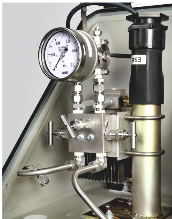
Пример подключения дифференциального манометра компонентами DK-LOK.
