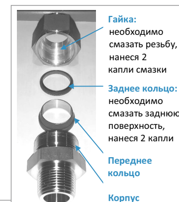
Рисунок 2. Эскиз фитинга с поверхностями для смазки
