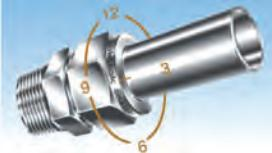
Затянуть гайку ключом на  $1\frac{1}{4}$  оборота так, чтобы отмеченная точка оказалась в положении часовой стрелки, указывающей на 9 часов.
