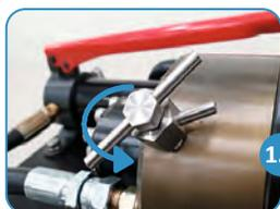
1.4 Качайте рукоятку насоса до тех пор, пока из системы не выйдет воздух. Это обеспечит надёжную и плавную работу инструмента.
