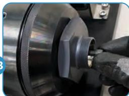
**2.3** Закрутите болт фиксации штампа в обжимной головке с помощью шестигранного ключа.
