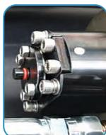
**4.3** Нажмите на индикатор до момента его фиксации в обжимном устройстве.
