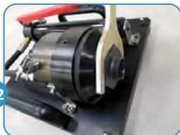
**2.2** Вкрутите от руки патрон DJI в обжимную головку и затяните гаечным ключом.
