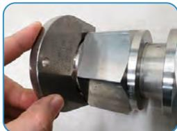
**ЕСЛИ ЩУП ПРОХОДИТ В ЗАЗОР** между гайкой и корпусом фитинга, то это означает, что требуется дополнительная затяжка.
