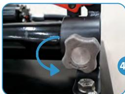
**4.4** Откройте перепускной клапан, отвинтите накидную гайку и извлеките предварительно обжатую сборку.
