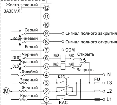
ТИП H: 3х-фазная цепь управления переменного тока (с переключателем пассивного контакта)
