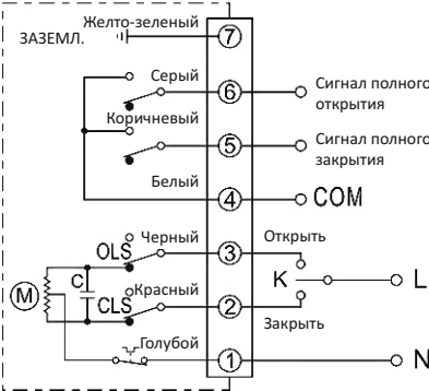
ТИП D: Позиционный выключатель с потенциометром и пассивным контактом
