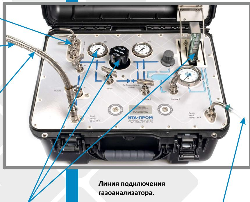
Линия подключения газоанализатора.
