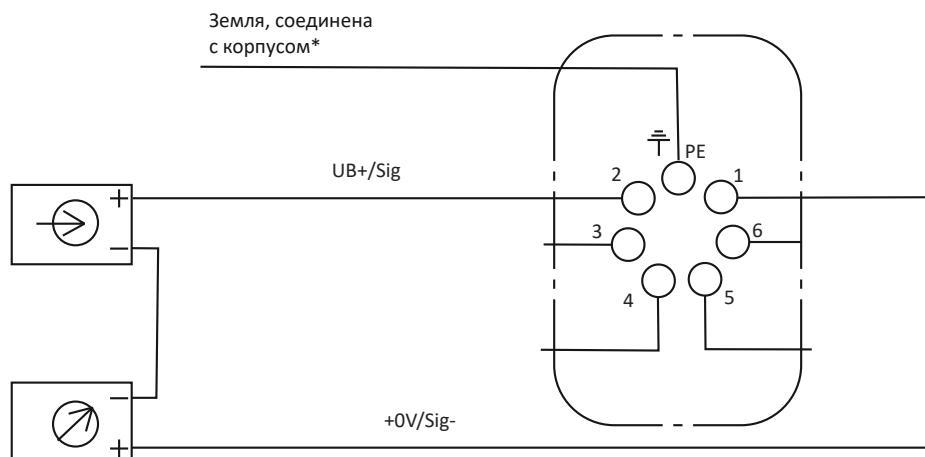
\* Данное технологическое присоединение не должно использоваться в качестве системы выравнивания потенциалов. Прибор следует подключать к системе выравнивания потенциалов через технологическое присоединение.
