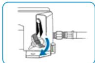
5.6 Откройте перепускной клапан, отвинтите накидную гайку и извлеките предварительно обжатую сборку.
