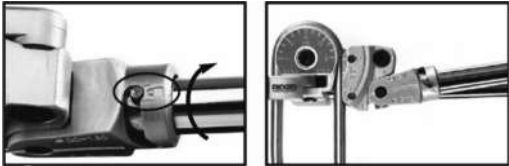
Рисунок 11 – Блокировка короткой рукоятки в положении 180° и гибка трубки
