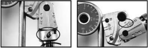
Рисунок 10 – разблокировка короткой рукоятки и установка в позицию 180°
